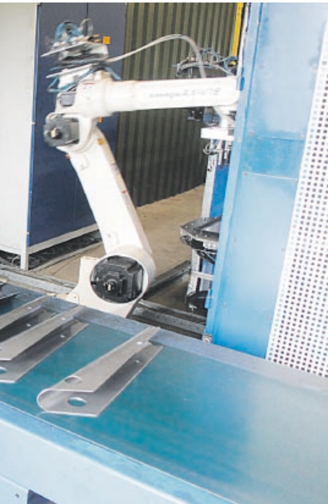
Door het plaatsen van een extra handlingsrobot is de cyclustijd met 25 procent omlaag gebracht.
