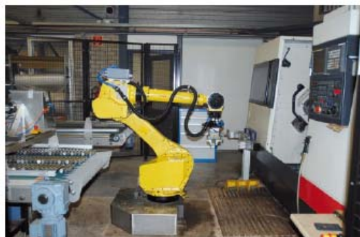
Een robot maakt betrouwbare onbemande productie mogelijk in de avonduren. Daardoor verbetert het rendement van de machines aanzienlijk.
